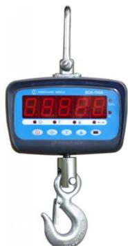
Легкие весы массой 3,3 кг для работы в помещениях. Оснащены вращающимся крюком. Отличаются широким диапазоном термокомпенсации от -30 до +40°C и функцией суммирования. Весы сигнализируют о перегрузке, превышающей НПВ на 10%. Яркий светодиодный индикатор, высота цифр 30 мм. Время взвешивания не превышает 5 с. В весы встроен аккумулятор (зарядное устройство входит в комплект), время работы от полностью заряженного аккумулятора 50 ч.
